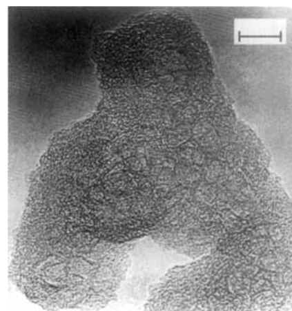
Abb. 3. Hochauflöste TEM-Aufnahme von Fullerenruß. Die Herstellungsbedingungen waren optimiert auf maximale C_{60} -Ausbeute. Man beachte die Hohlräume innerhalb der kontinuierlichen Kohlenstoffschleifen. Der verstärkte Kontrast der Schleifen deutet auf den zweidimensionalen Charakter weniger paralleler Schichtpakete hin (vergleiche dazu Abb. 2). Die Balkenlänge entspricht 10 nm.
